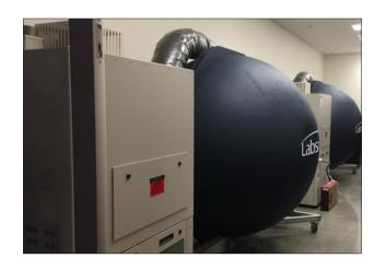
境会受到设计和应用环境的影响。一个灯具通过测量灯具在不同温度下的性能特征,就可以建立工作温度和光输出的关系模型。蓝菲光学(Labsphere)的 illumia®Plus2 温控积分球光谱仪测试系统是依据 IES LM-82 和 LM-79-19 建议的方法在较宽的动态温度范围内测试光度和比色性能而专门设计的。系统包括一个积分球(尺寸 1.65 米和 2 米可选)与温度控制反馈回路,应用特定模块,认证的标准灯和 Integral®软件。
