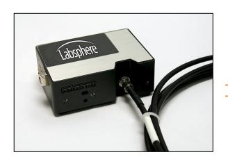
CDS-600/610 阵列光谱仪是一款快速光谱分析器,主要用于实时光谱分析,瞬时光谱采集功能。可以测得待测器件(DUT)在辐射、光度和色彩方面的多种特性。该高灵敏度 CCD 阵列光谱仪具有噪音低、光谱响应范围广的特点,它配合 Labsphere 积分球技标准源使用,即便针对一些窄带光源应用,如 LED、荧光灯和放电灯,也能获得精确的测量数据。
